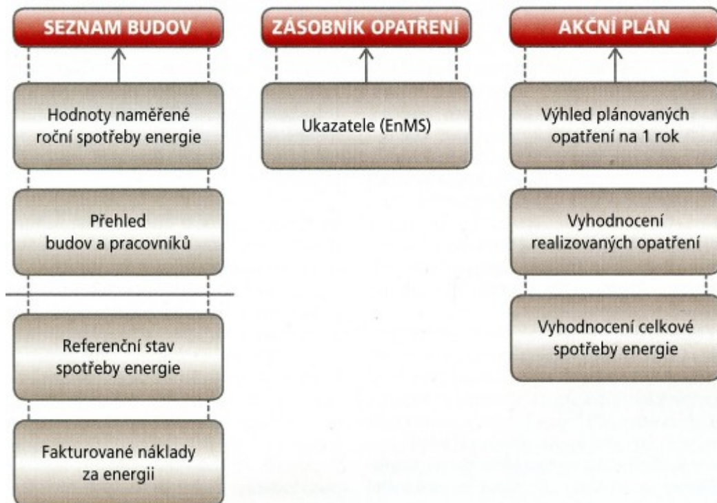
Obrázek 58: Činnosti, sledované ukazatele a struktura energetického managementu
